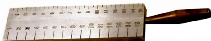
Рисунок 5 – Общий вид клинового промерника
